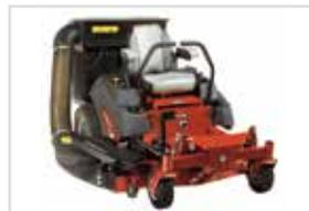
**Système de ramassage "TURBO-PRO" pour 400S.** Système de collecte à 2 bacs de 227 litres avec turbo d'assistance.
